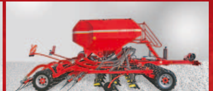
Посевной комплекс Horsch Sprinter ST (SW) ширина захвата от 4 до 12 м двухпотоковые анкерные сошники Andersona
