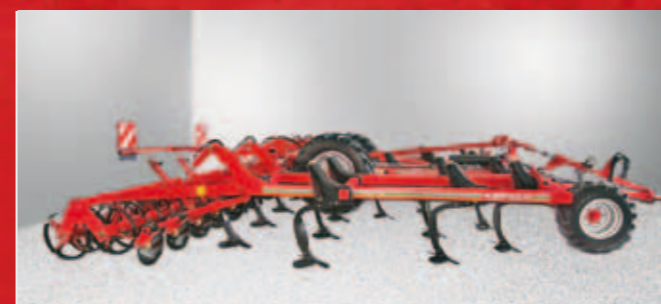
Стерневой культиватор Horsch Terrano FM ширина захвата от 5 до 12 м четыре ряда лап MulchMix на стойках TerraGrip
